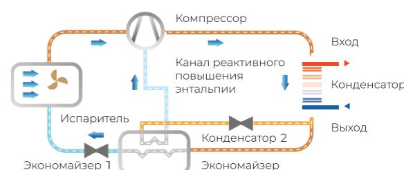
\* Используется в модульных тепловых насосах TCL
