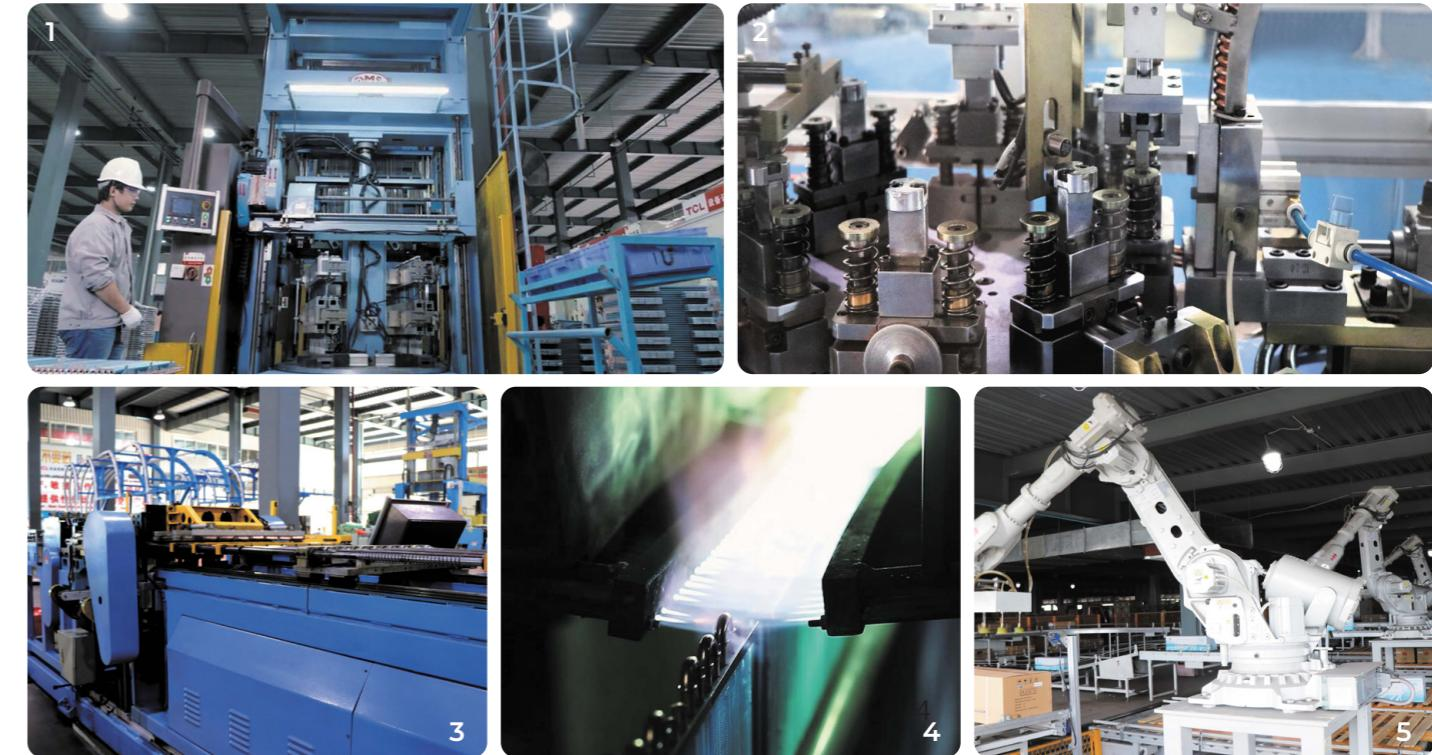
Высокую эффективность производства и обороты на заводах TCL обеспечивают автоматические линии производства, которые применены для расширения и сгибания труб (рис.1, 2), U-образных элементов (рис.3), сварки труб (рис. 4), транспортировки и упаковки продукции (рис. 5)
